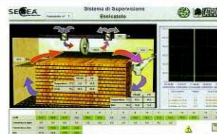
コンピュータで乾燥スケジュールを管理することで、安定した品質を確立
