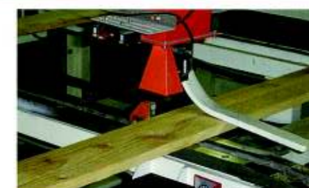
乾燥度をチェックするマイクロ波木材含水率測定機により、設定した品質水準に達しているかどうかチェック
