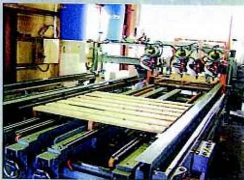
パレット表面打立状況
