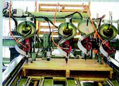
パレット裏面打立状況
